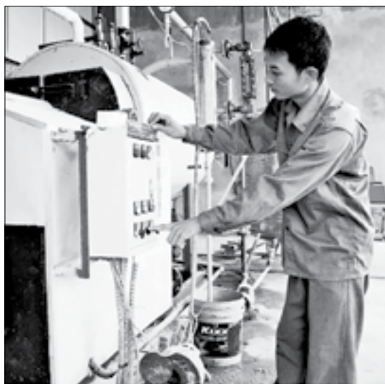
▲ Lò sấy nguyên liệu bằng hơi nước sử dụng phế liệu nứa, vầu tại làng nghề Quảng Phú Cầu
